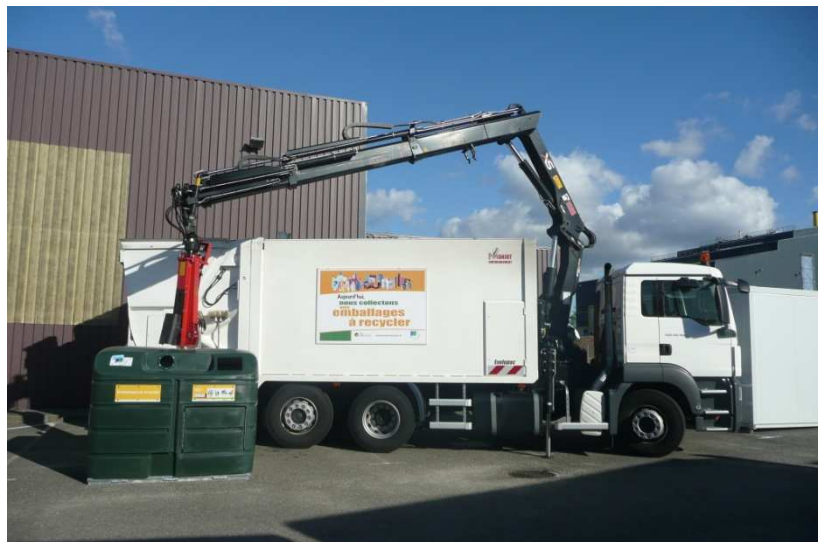
3.3.1 Camion de compaction équipé d'une grue auxiliaire : EVOLUPAC
